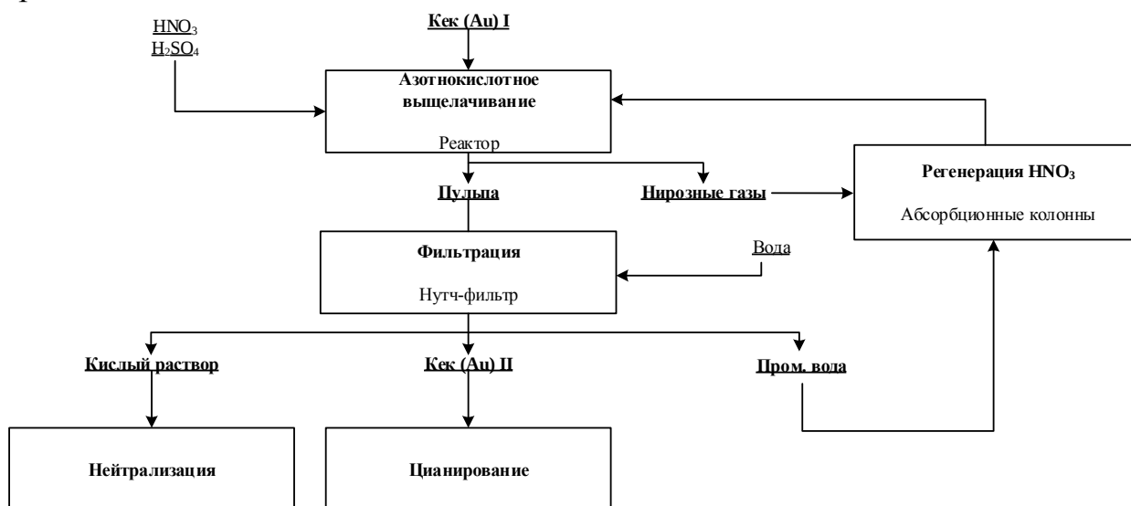
Рисунок 14 – Предлагаемая технологическая схема переработки обессурьмяненного кека
