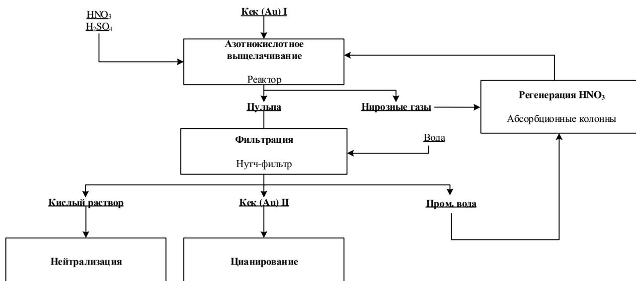
Рисунок 5.2 – Принципиальная технологическая схема азотнокислотного выщелачивания обесурьмяненного
