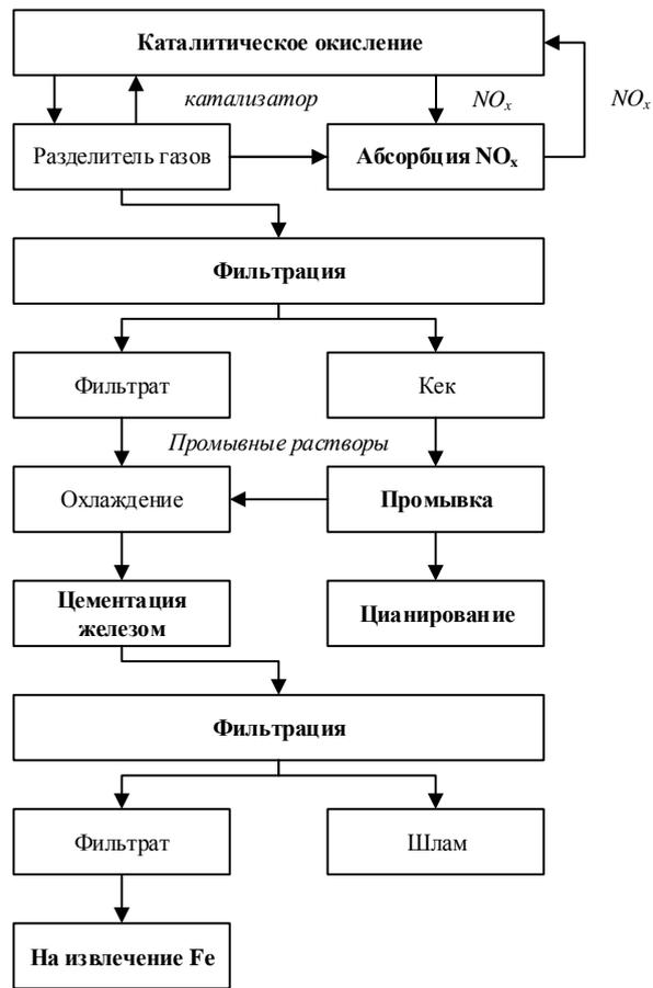
Рисунок 1.4 Принципиальная схема NSC-процесса
