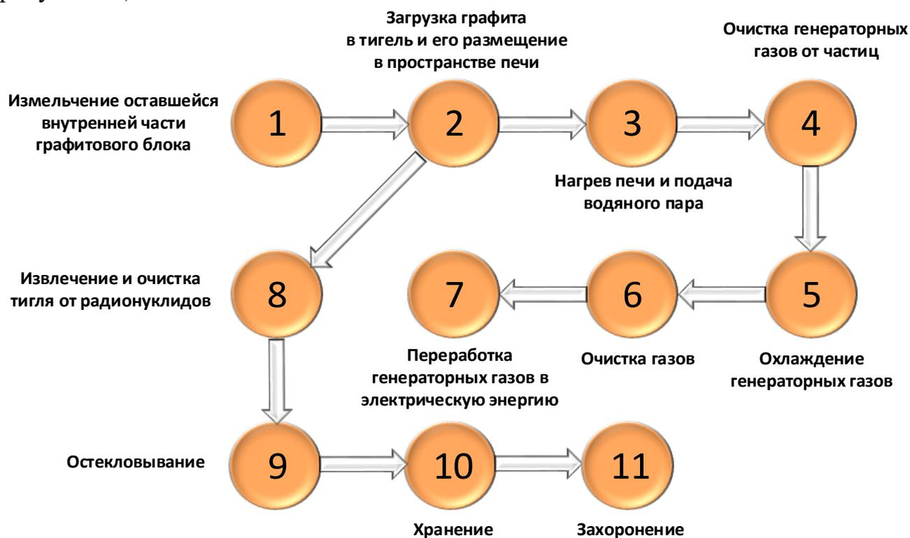
Рисунок 13 – Технологическая схема переработки реакторного графита комбинированным способом Ч.2
