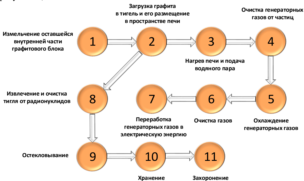
Рисунок 13 – Технологическая схема переработки реакторного графита комбинированным способом Ч.2
