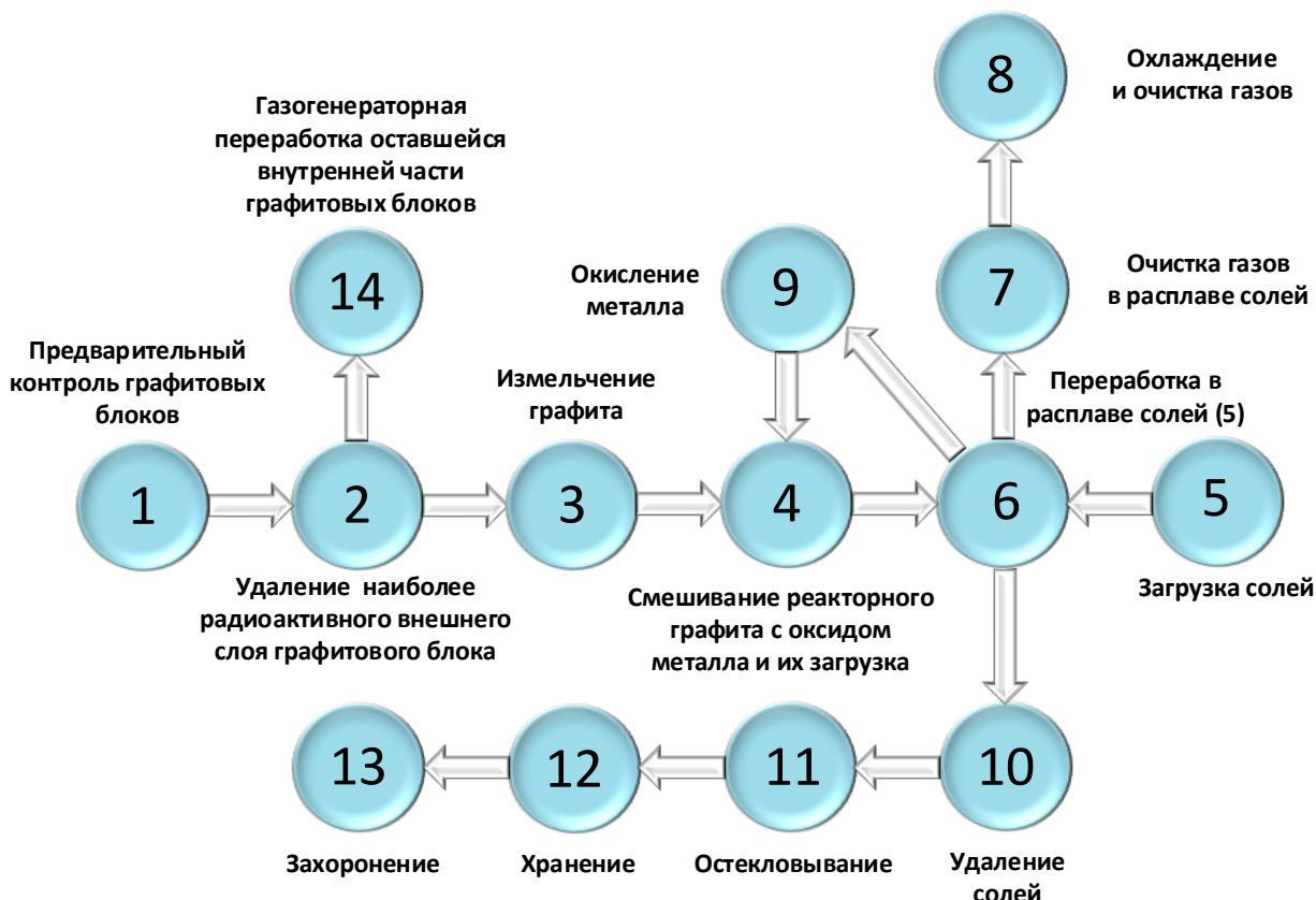
Рисунок 11 – Технологическая схема переработки реакторного графита комбинированным способом Ч.1
