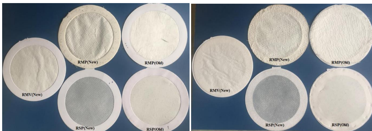
Рис. 1.7. Внешний вид передней и задней сторон фильтров АФА-РСП-20, АФА-РМП-20 (новые и старые) и фильтров АФА-РМВ-20
