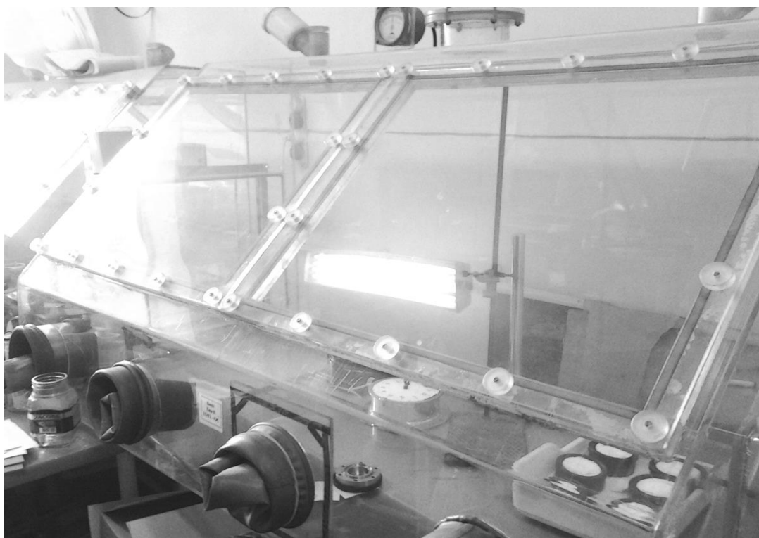
Рис. 2.9. Конструкция камеры для отбора проб аэрозолей ДПР радона
