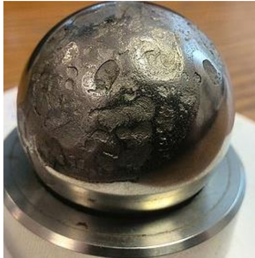
Рисунок 5. Изношенный стеллитовый шар клапанной пары
