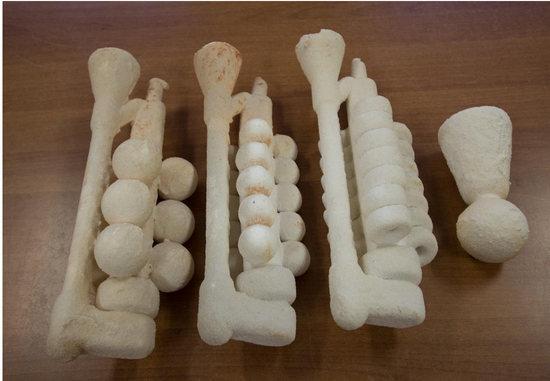
Рисунок 55. Литейные формы для получения отливок «Шар» и «Седло»
