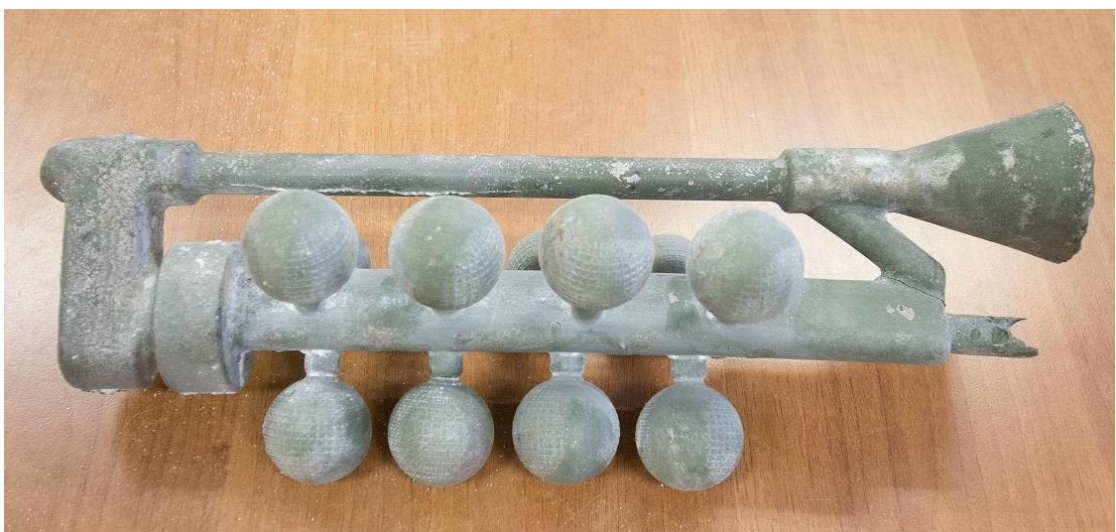
Рисунок 56. Блок отливок «Шар V11-225» из кобальтового стеллита Mk1
