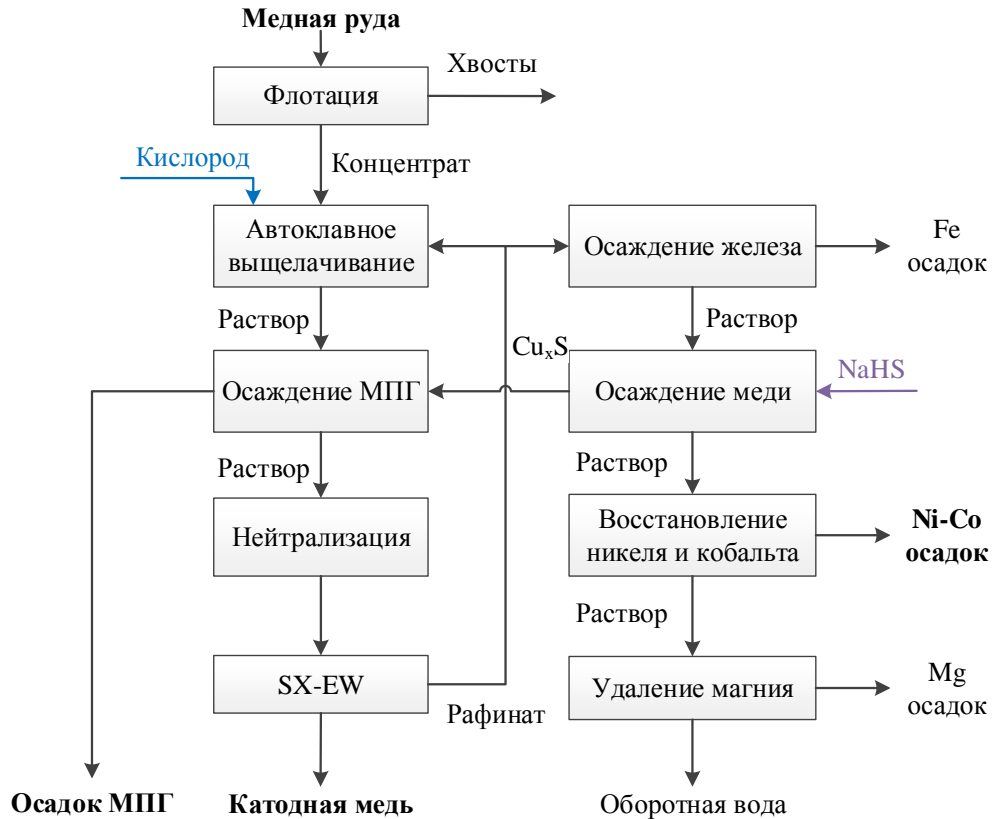
Рисунок 9 - Технологическая схема процесса Platsol.
