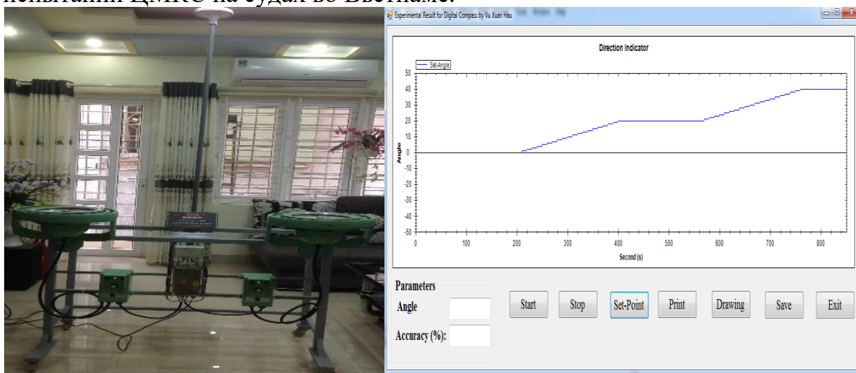
а) б) Рисунок 12 – Исследовательский стенд с реальной ЦМКС (а) и интерфейс ПО для тестирования ЦМК (б)
