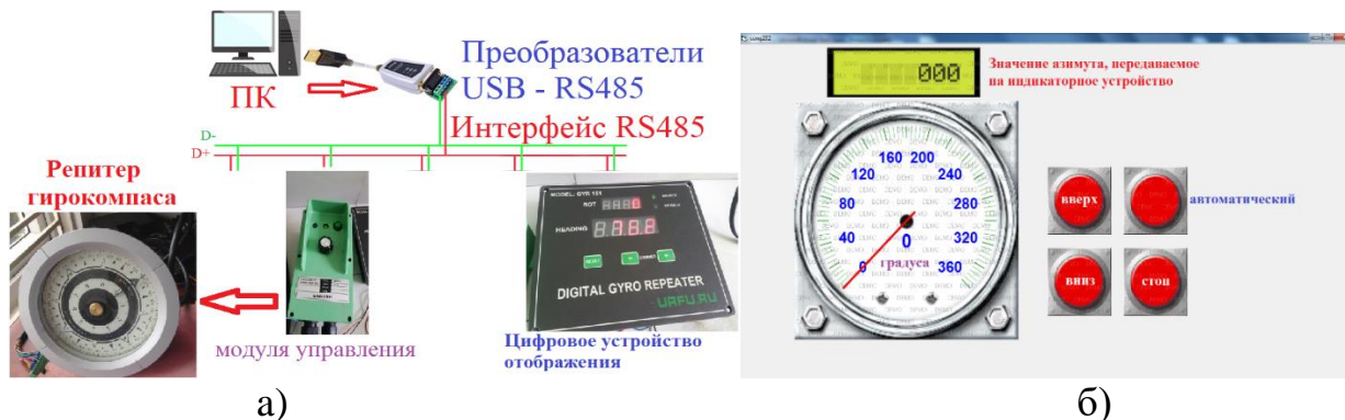
Рисунок 24 – Схема подключения компьютера и тестовых устройств (а), Интерфейс программного обеспечения для тестирования индикаторных устройств (б)
