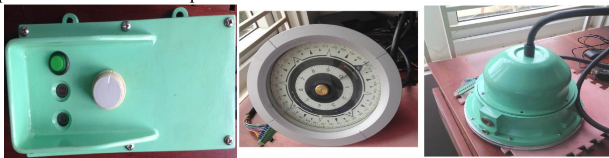
Рисунок 7 – Результаты разработки репитера гирокомпаса
