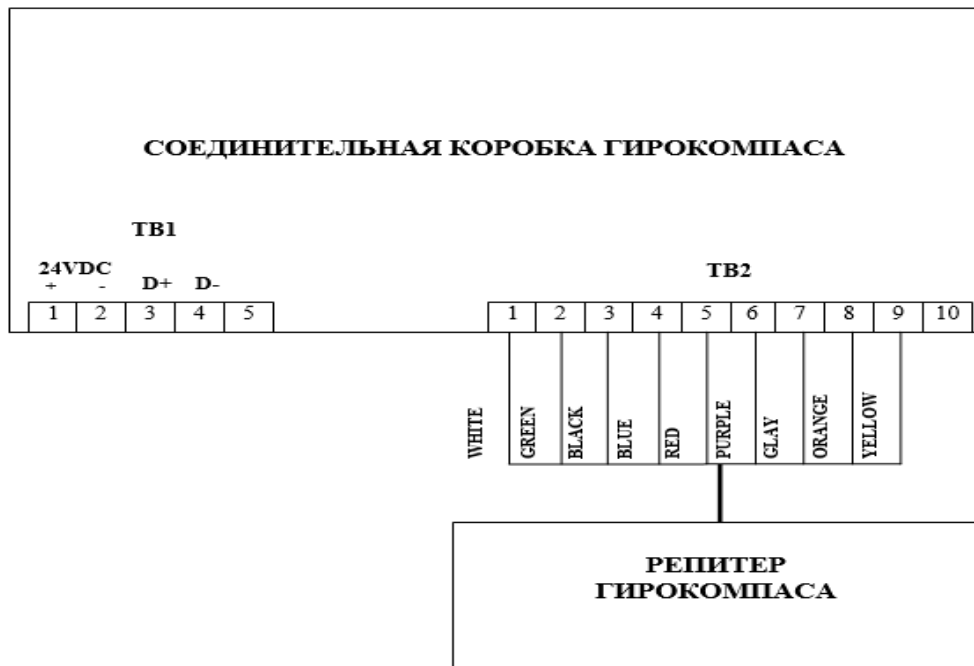
Рисунок 4.2. Схема подключения репитера гироскопа к блоку управления устройства
