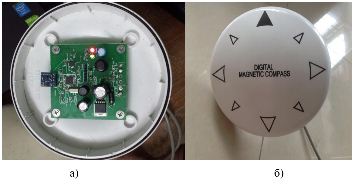
Рисунок 2.21. Вид ЦМК (а) и его размещение в корпусе (б)
