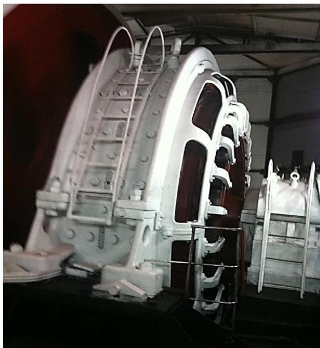
Рис. 1.1.1. Электродвигатель, маховик и стояковый подшипник
