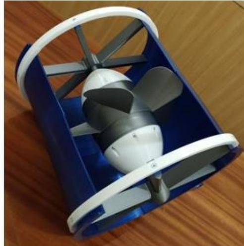
Рисунок. 5.4.7. Фотографии масштабной модели двигателя, изготовленной по технологии 3D принтера
