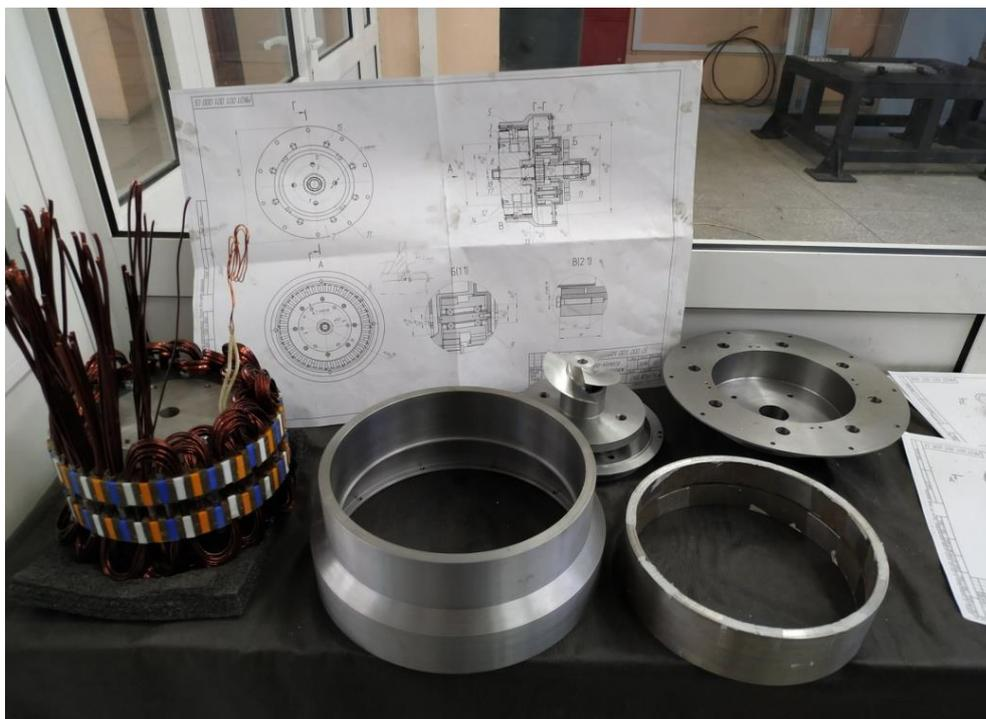
Рисунок. 5.4.8. Основные детали и сборочные узлы гидрогенератора 3 кВт.
