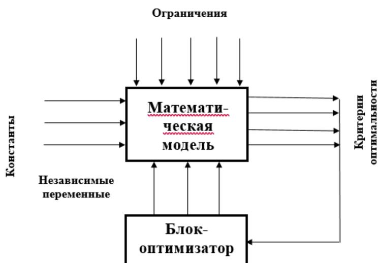
Рис.3.1. Блок-схема задачи однокритериальной оптимизации
