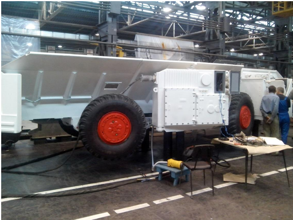
Рис. 6.3. Наладка электропривода самоходного вагона
