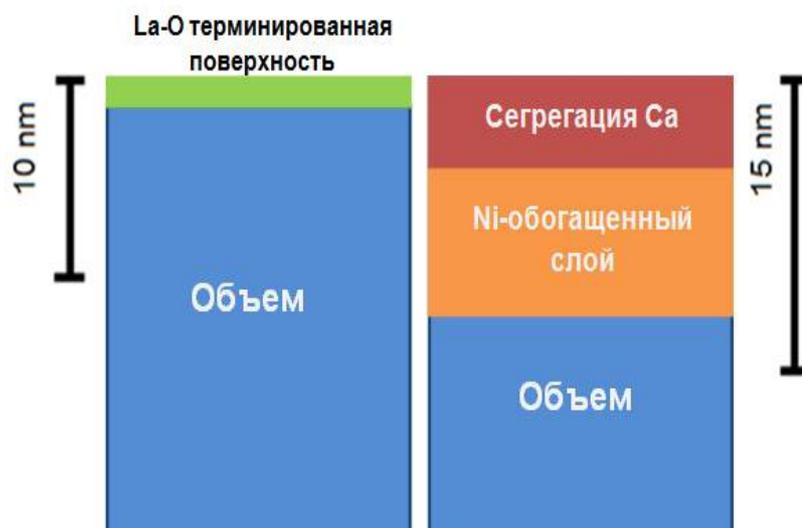
Рисунок 3.10 – Схематическое изображение приповерхностных слоев и объема оксидов  $\text{La}_2\text{NiO}_{4+\delta}$  и  $\text{La}_{1.7}\text{Ca}_{0.3}\text{NiO}_{4+\delta}$ .
