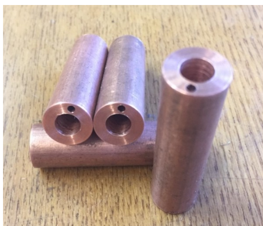
Рисунок 2.12. Цилиндрические элементы теплообменника
