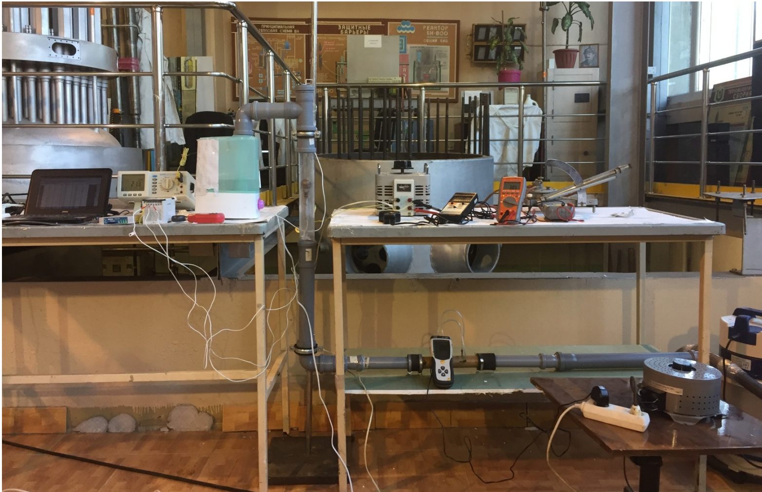
Рисунок 2.3. Внешний вид экспериментальной установки для исследования теплообмена с одиночным шаровым элементом
