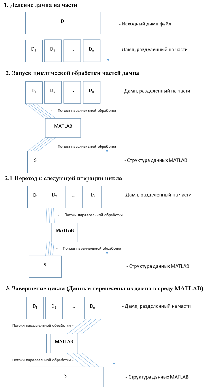
Рис. 6. Схема процесс переноса данных из pcap-файла в рабочее пространство пакета MATLAB
