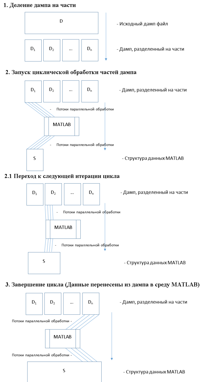
Рис. 3.1. Схема процесс переноса данных из pcap-файла в рабочее пространство пакета MATLAB
