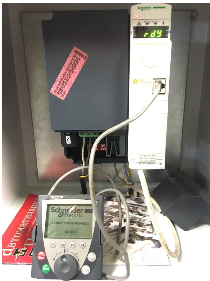
Рисунок 3.6.2 – Частотный преобразователь и интерфейс ввода данных стенда СГСУ-3000.
