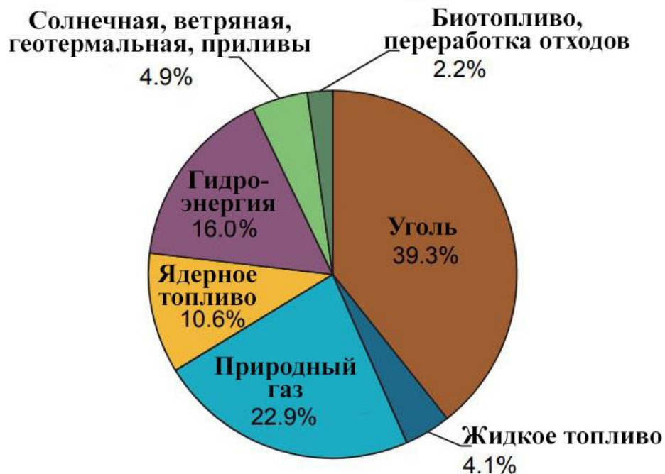
Рис. 1.1. Распределение произведенной электроэнергии в мире по типу источника энергии, по данным на 2015 г. [1]
