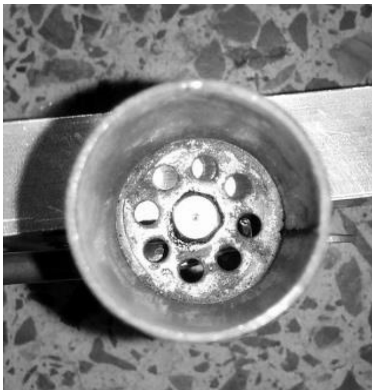
Рис. 2.2. Прямоточная эжекционная горелка, вертикально закрепленная на кронштейне внутри каркаса экспериментальной установки. Вид сверху
