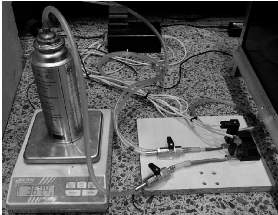
Рис. 2.3. Газовый баллон на весах (слева) и клапанный блок (справа). Клапанный блок состоит из двух параллельных линий подвода топлива (основная и запасная)
