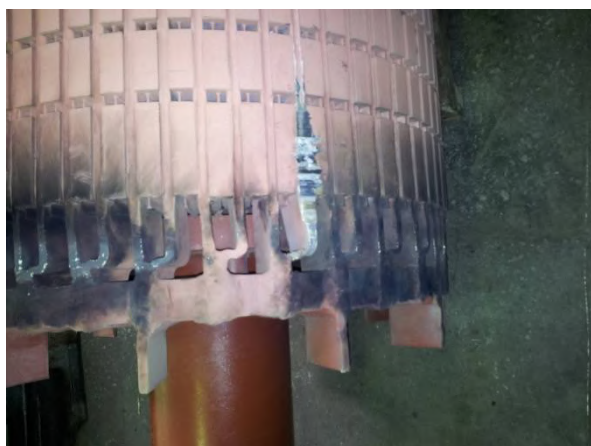
Рисунок 6.1 – Выход стержня ротора двигателя АДЧР-1600-6.0-4У1 из паза
