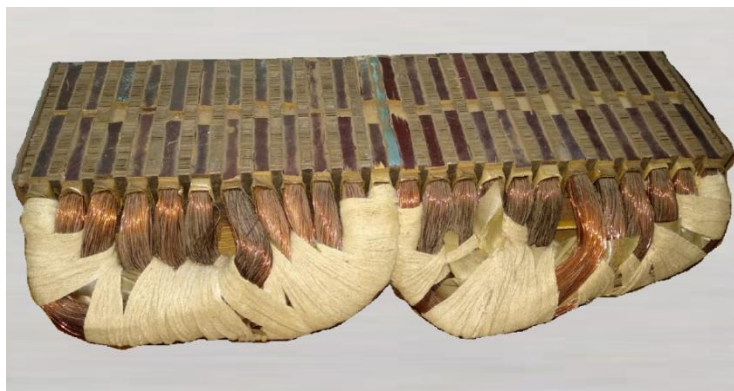
Рисунок 5.4 – Внешний вид индуктора ЛИМ6
