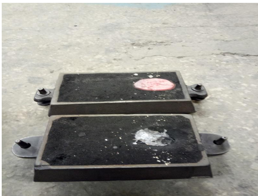
Рисунок 4.1 - Опока с формовочной смесью после заливки в неё чугуна
