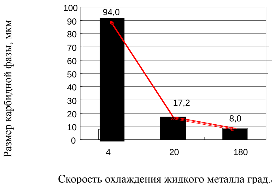
Рисунок 2.4 - Влияние скорости охлаждения жидкого металла (20,0-25,0 мас. % Al) на размер карбидной фазы
