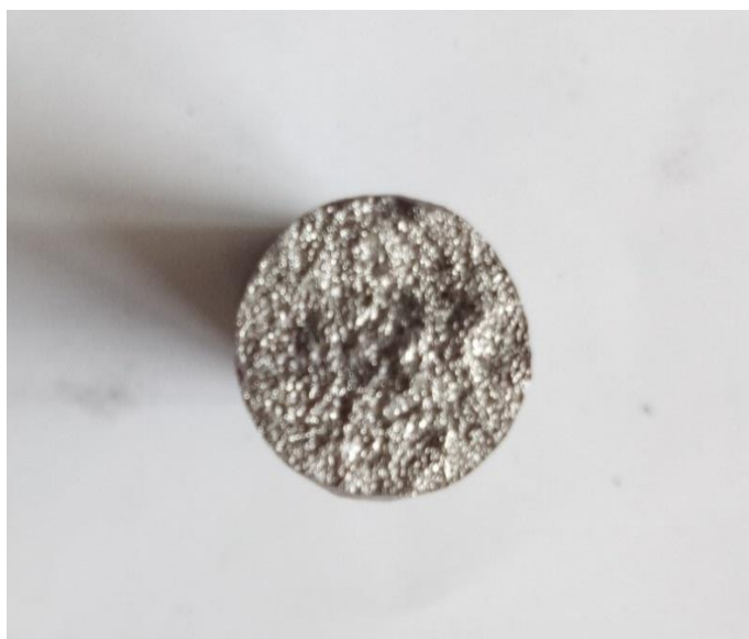
Рисунок 4.3 - Макроструктура излома образца ( d=5,0 мм) слитка металла
