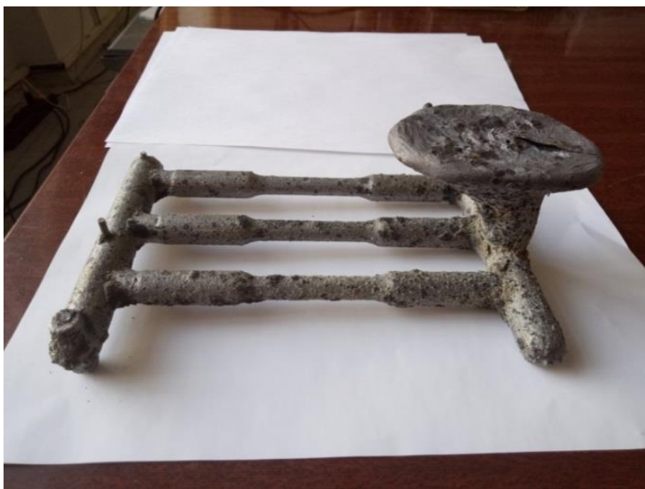
Рисунок 4.2 - Образец готовой отлитой заготовки с прибыльной и летниковой частями
