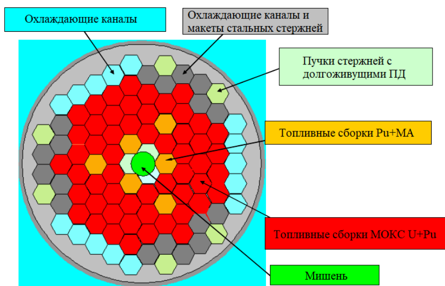
Рисунок 1.4 – Конфигурация а.з. MYRRHA для исследований трансмутации МА и долгоживущих ПД
