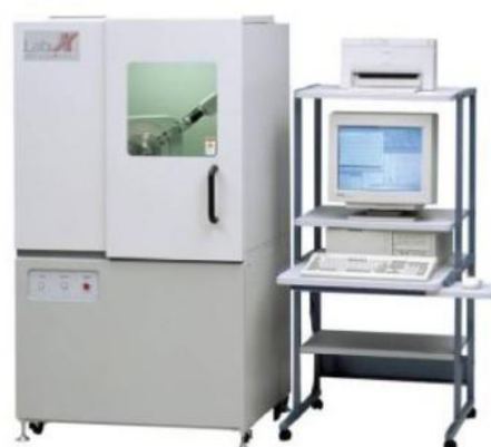
Рисунок 5. Рентгеновская дифракционная машина Shimadzu (XRD-6000)
