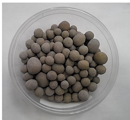
Рисунок 7 – Внешний вид безобжигового зольного гравия
