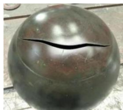
Рисунок 23 - Разрушение заготовки на четвёртом переходе вытяжки
