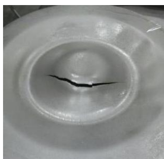
Рисунок 18 - Разрушение заготовки в точке 2 на первом переходе штамповки
