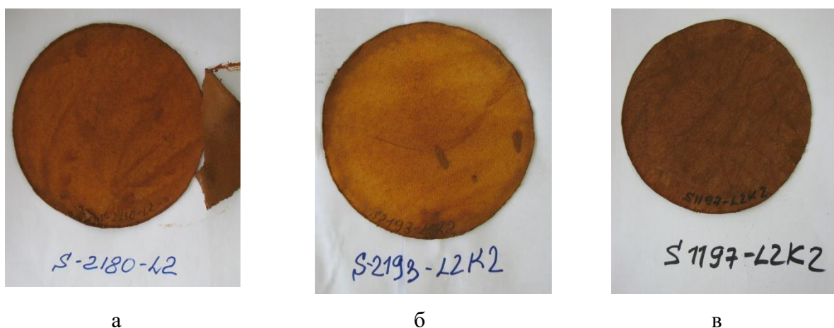
Рисунок 4.7 – Изображение фильтровальной салфетки после проведения фильтрования пульпы выщелачивания полиметаллического шлама на лабораторном вакуум фильтре
