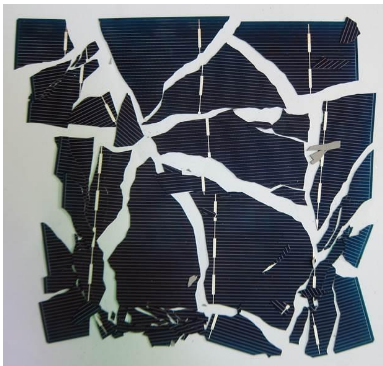
Рисунок 2.4 – Дефекты элементов класса D
