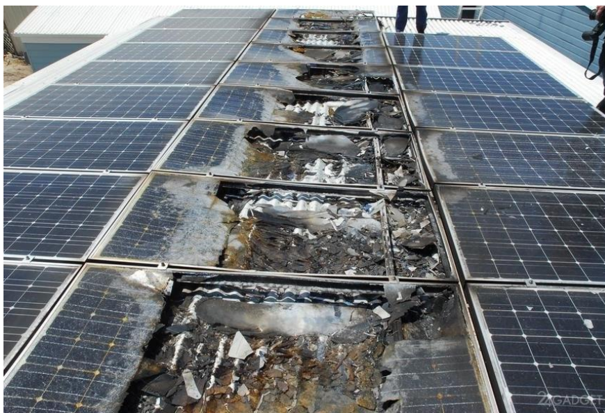
Рисунок 2.8 – Последствия возгорания ФЭМ на СЭС
