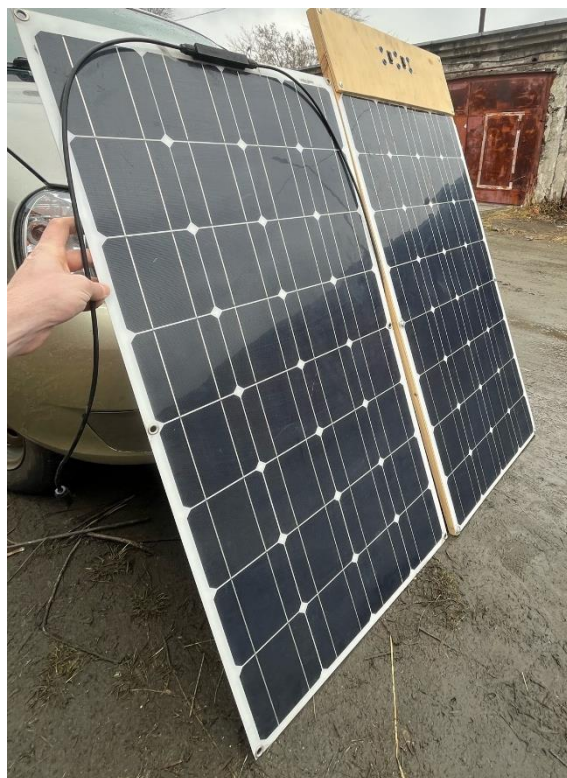
Рисунок 4.6 – Компланарное размещение эталонного и испытуемого ФЭМ для определения энергетической освещенности
