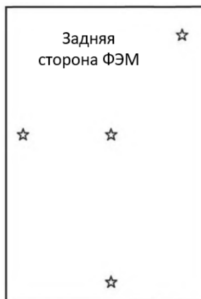
Рисунок 4.7 – Размещение точек измерения температуры на ФЭМ
