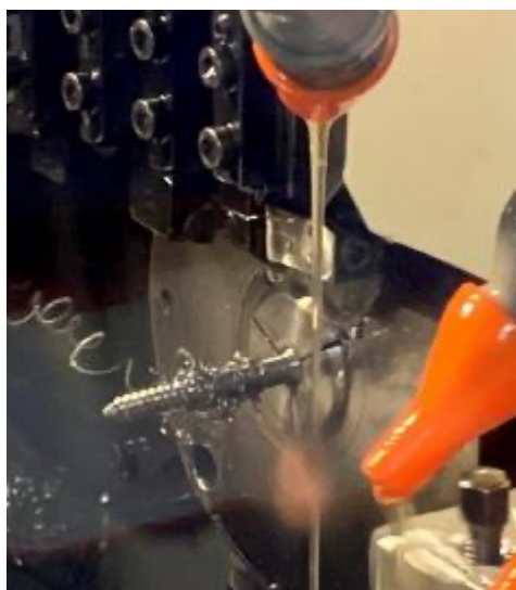
Рисунок 5.2 – Обработка на станке (а) и внешний вид (б) готового имплантата для остеointеграционного протезирования
