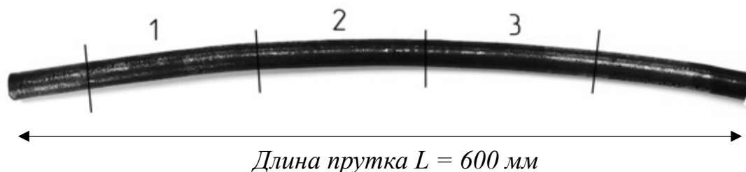
Рисунок 2.4 – Фото прутка после РК и схема вырезки заготовок для изготовления образцов и имплантатов
