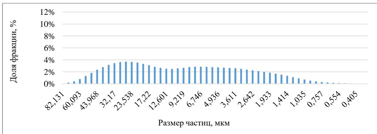
Рисунок 2.15 – Гранулометрический состав наполнителя фирмы ООО «Родонит»
