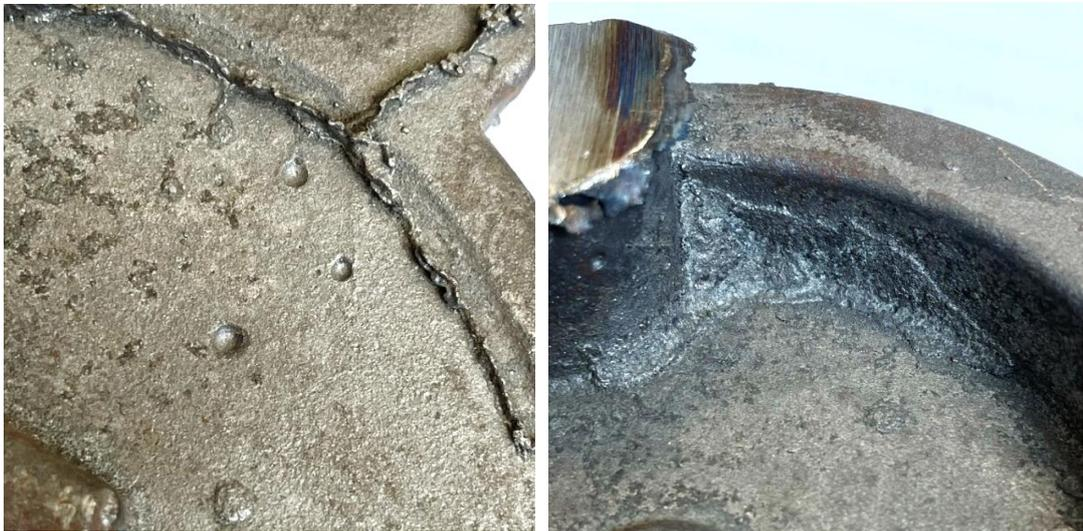
Рисунок 4.3 – Дефекты на отливке «Крышка корпуса»
