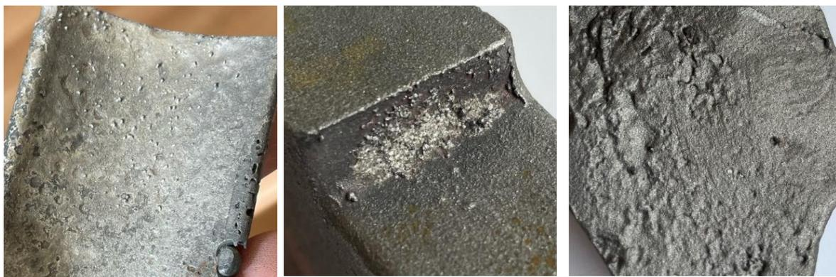
Рисунок 1.5 – Дефекты поверхности отливок
