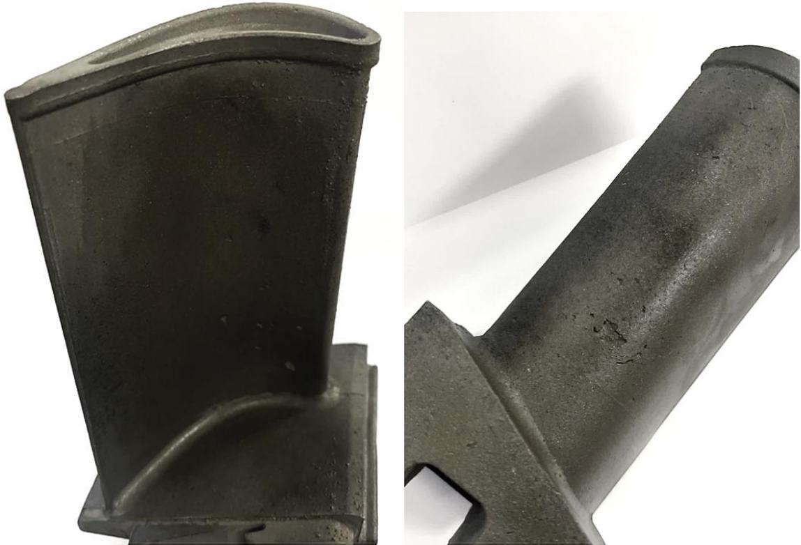
Рисунок 4.2 – Дефекты на отливке «Лопатка направляющая»
