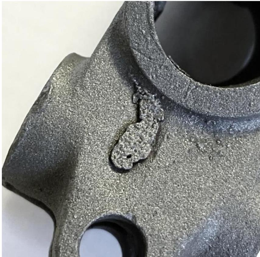
Рисунок 4.5 – Дефекты поверхности на отливке «Опора»
