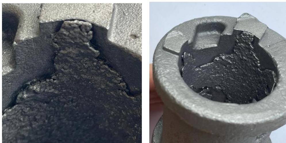
Рисунок 1.12 – Дефект на отливках после отслоения керамической оболочки
