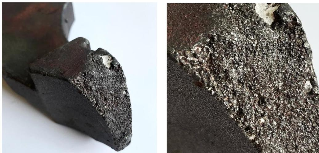
Рисунок 1.13 – Дефект отливки в виде пригара
