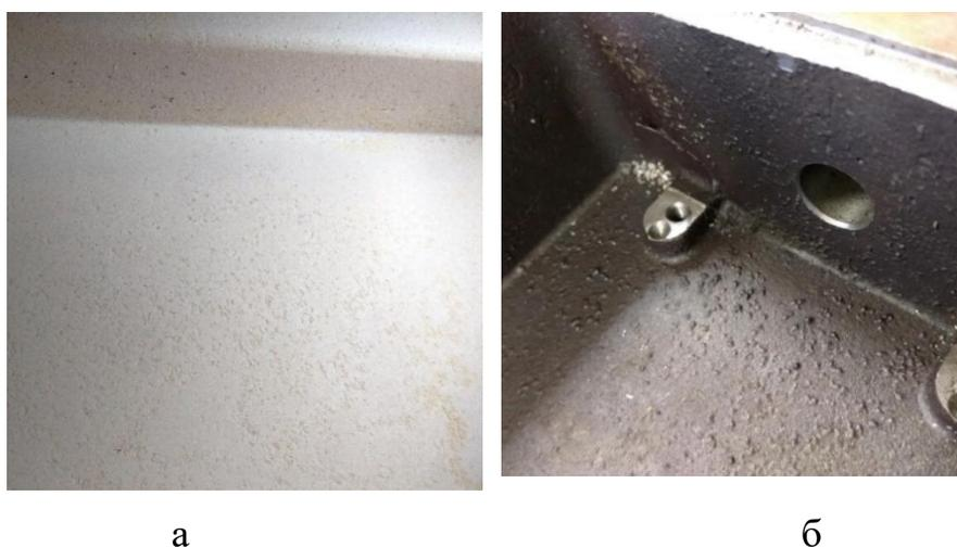
Рисунок 4.9 – Дефект «пробой»: а – поверхность контактного слоя керамической оболочки, б – итоговая отливка
