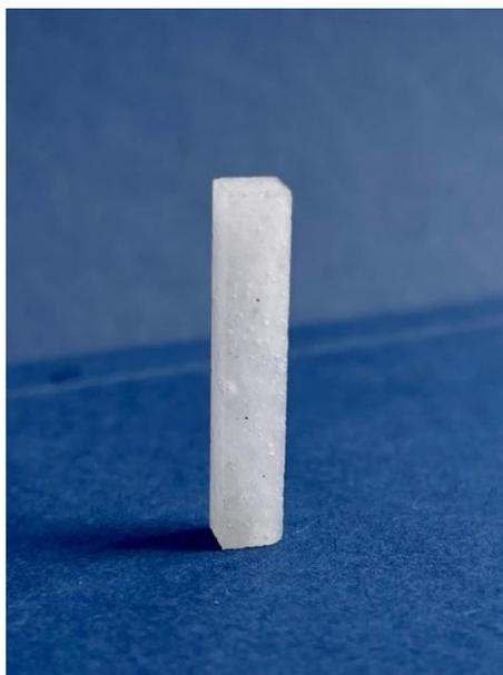
Рисунок 3.3 – Образец для исследования ТКЛР из монолита плавленного кварца
