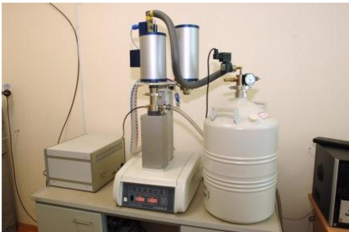
Рисунок 3.2 – Внешний вид дилатометра «Linseis L75VD1600C»
