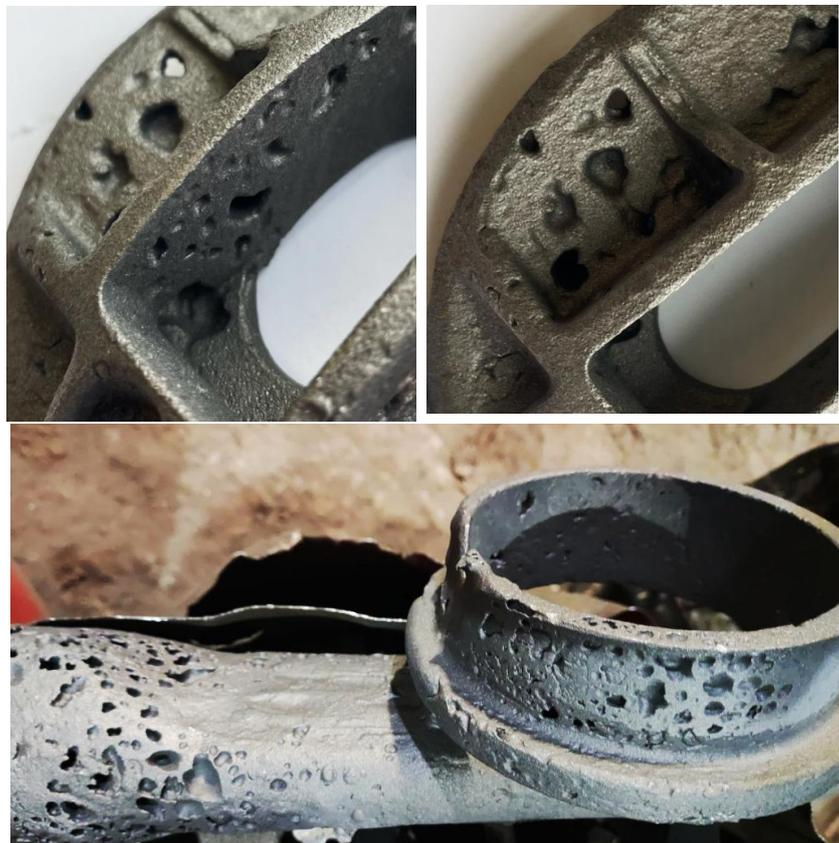
Рисунок 1.10 – Дефект в виде скопления газовых раковин
