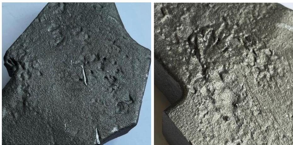
Рисунок 1.8 – Дефект в виде шероховатости, возникшей из-за газовой пористости
