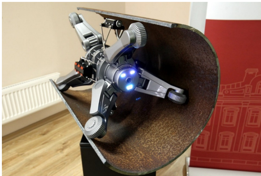
Рисунок 4.25 - Роботизированный комплекс с акустическим датчиком
