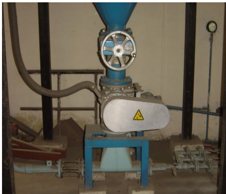
Рисунок 3.30 - Роторный питатель, используемый в новой пилотной установке
