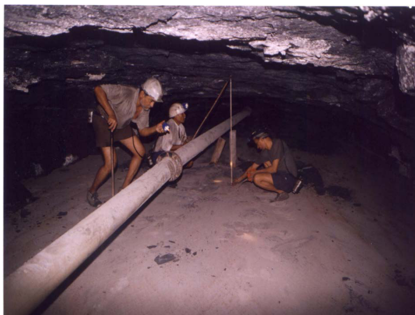
Рисунок 1.13 — Заполнение шахт золошлаковой пульпой в Индии
