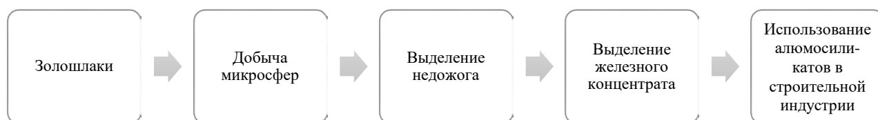
Рисунок 5.4 - Принципиальная схема этапов комплексной переработки золошлаков ТЭС
