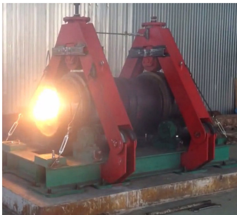
Рисунок 4.22 - Установка центробежного литья для нанесения покрытия на трубы диаметром 530 мм
