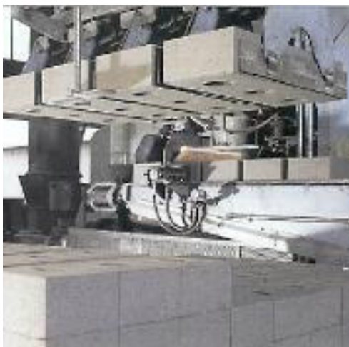
Рисунок Н.18 - Производство силикатного кирпича, Бохум, Германия
