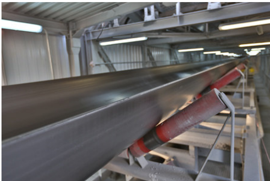
Рисунок 2.16 — Трубный ленточный конвейер для транспорта золы до золоотвала
