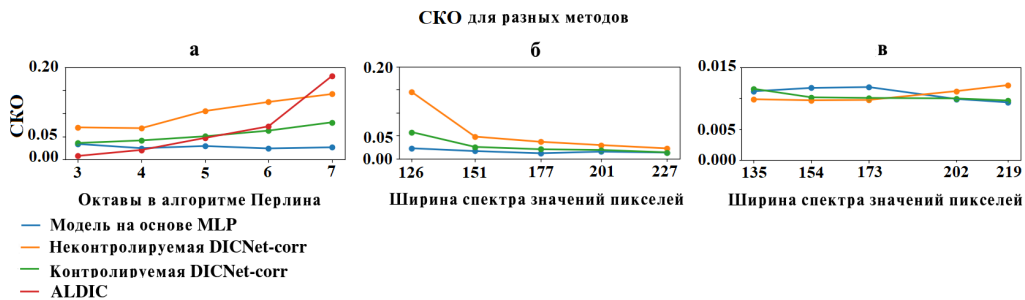
Рис. 3 — а - Пример графика зависимости СКО от октавы в алгоритме Перлина (плотности поля смещения) для разных методов для случая незашумленного изображения (ширина спектра значений пикселей 126); б - Пример графика зависимости СКО от ширины спектра значений пикселей (незашумленные изображения) для разных методов (октава в алгоритме Перлина 5); в - Пример графика зависимости СКО от ширины спектра значений пикселей (зашумленные изображения) для разных методов (октава в алгоритме Перлина 7). Размер изображений 240x240.
