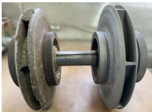
Рисунок 6 – Модифицирование рабочего колеса пожарного насоса НЦПН-40/100 с помощью МПУ МАК-100:
