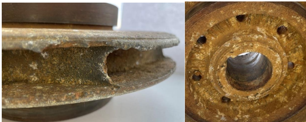
Рисунок 5.4 – Фотографии деталей рабочего колеса насоса с повреждениями
