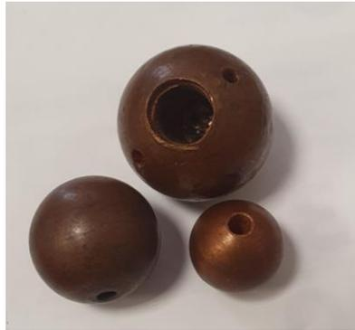
Рисунок 4.2 – Фотография медных шаров-калориметров разного диаметра
