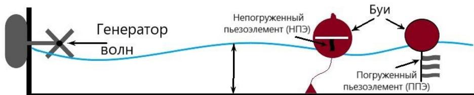
**Рисунок 4** Принципиальная схема экспериментальной установки
