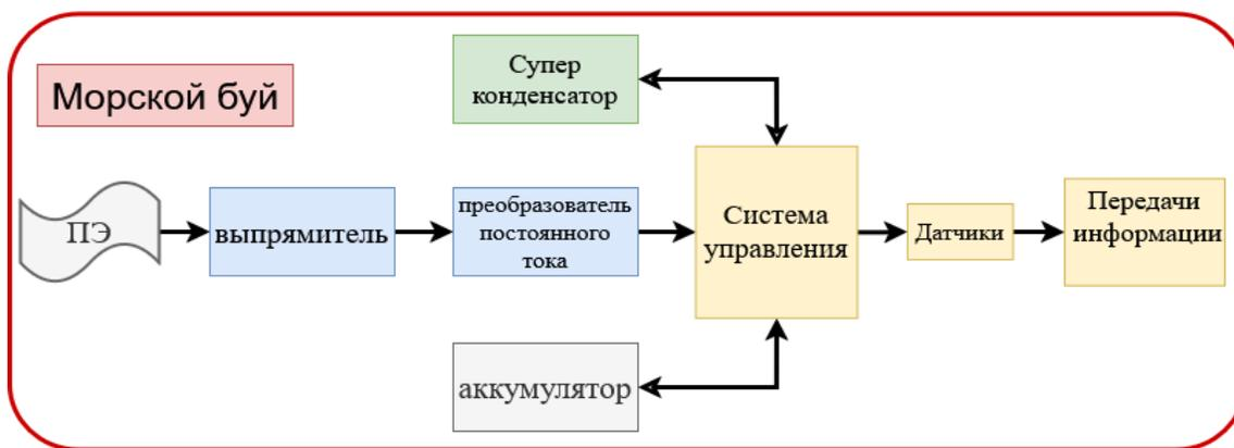
**Рисунок 14** Принципиальная схема предлагаемой системы
