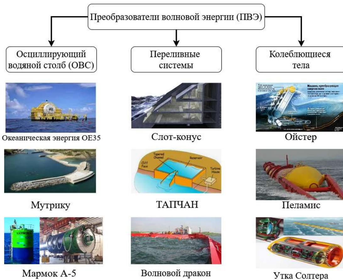
**Рисунок 1.1** Классификация ПВЭ по принципу работы
