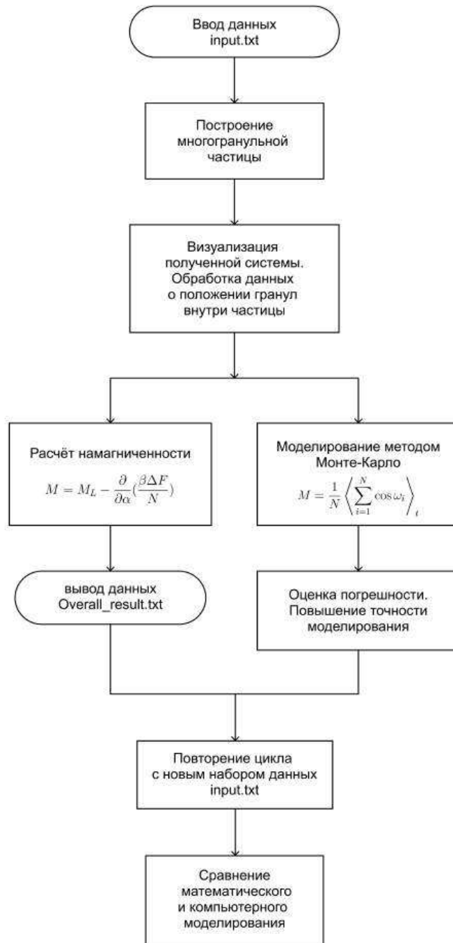
Рис. 4.3.3 – Блок-схема алгоритма второго программного комплекса.
