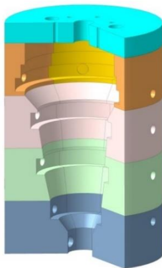
Рисунок 1.5 – Форма огнеупорной ванны плавителя
