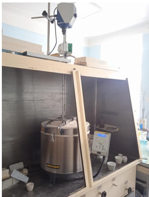
Рисунок 2.5 – Установка для динамических испытаний огнеупоров в расплаве стекла
