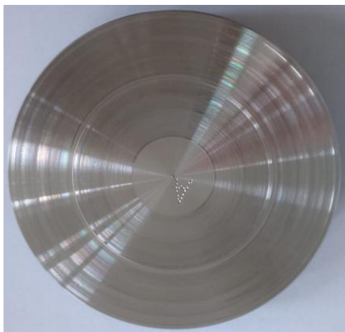
Рисунок 14 – Фотография стальной заготовки после чистового точения и обработки выглаживанием на токарно-фрезерном центре
