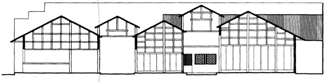
*Рис.51. Разрез сычуаньского сыхэюаня с объединённым залом (схема Ли Сянькуй)*
