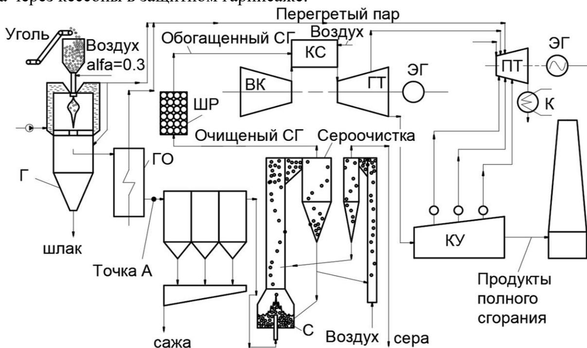
Рисунок 1 – Схема ПГУ-ВЦГ
