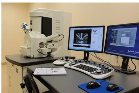
Рисунок 2.4 – Сканирующий электронный микроскоп *EVO LS 10*
