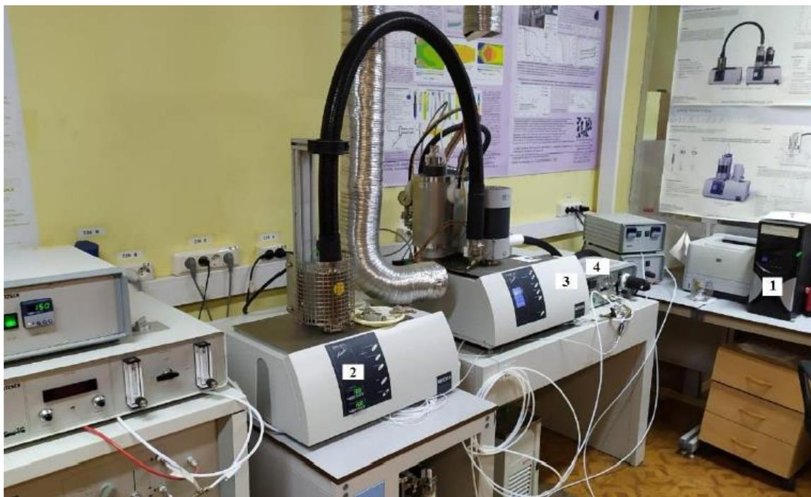
Рисунок 2.3 – внешний вид термогравиметрического анализатора<sup>2</sup>
