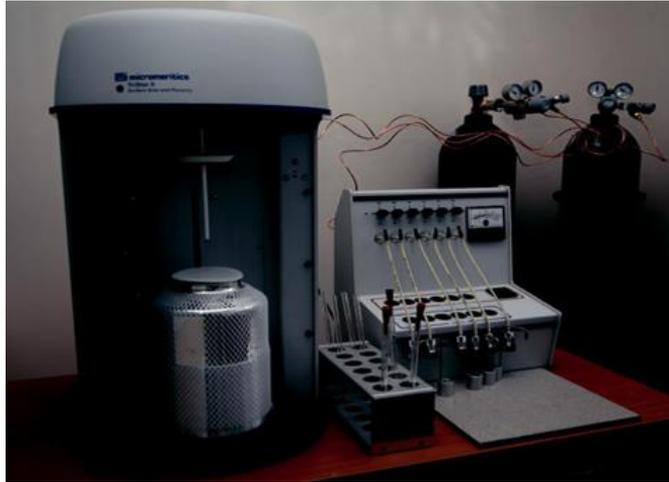
Рисунок 2.5 – Анализатор удельной поверхности TriStar 3000
