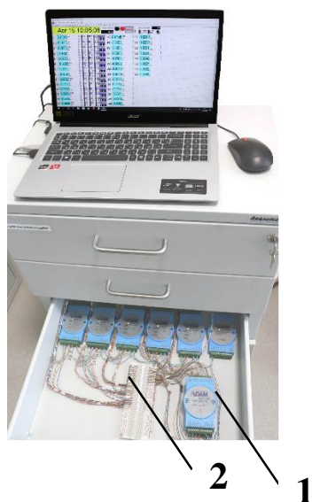
Рисунок 34 – Стенд с выдвинутым лотком с измерительными модулями ADAM-4000 и платой для установки нагрузочных резисторов
