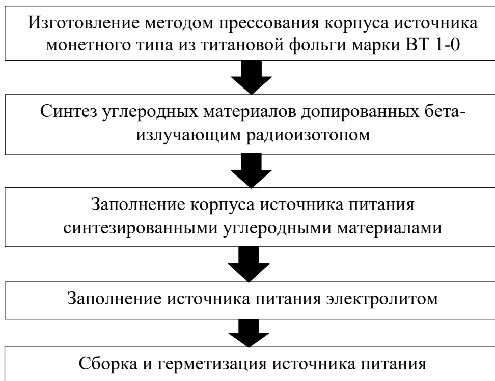
Рисунок 32 – Схема изготовления источника питания
