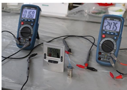
Рисунок 54 – Напряжение (2,475 В) и ток (16,0 мкА) на АИП через 3 минуты после подключения часов
