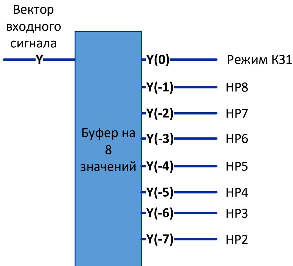
Рисунок 3.12 – Состояние буфера на 8 значений в момент времени t_1
