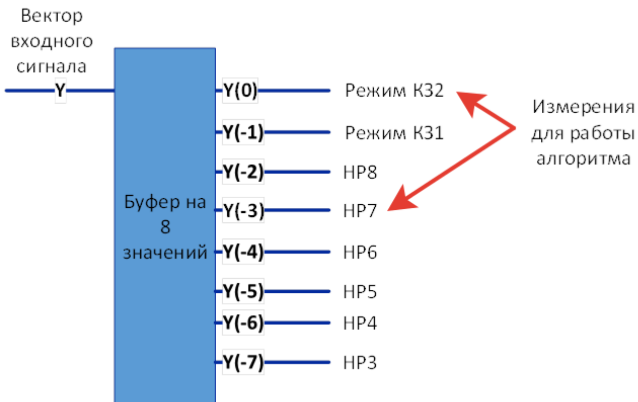
Рисунок 3.13 – Состояние буфера на 8 значений в момент времени t_2
