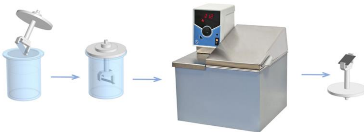
Рисунок 1.1 – Методика химического осаждения пленок PbS, PbS(I), PbS(I, Ni) и PbS(I, Co)
