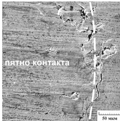
Рисунок 1.26 – Вид пятна контакта (СЭМ) после контактно-усталостных испытаний с максимальной нагрузкой P_{max} = 6,67 кН ( \sigma_{z max} = 7520 МПа) с числом циклов нагружения N = 10^6 стали У10 со структурой тонкопластинчатого перлита после фрикционной обработки. Штриховой линией обозначен край пятна контакта
