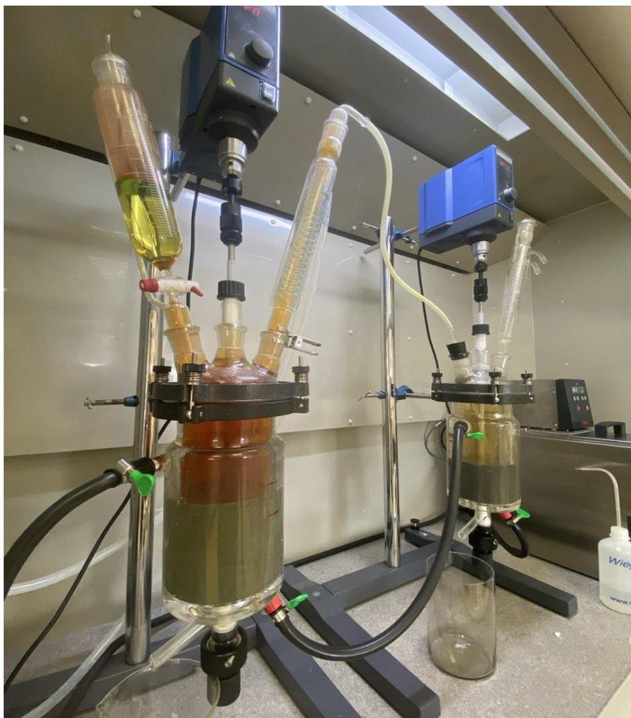
Рисунок 2.5 – Лабораторная установка для азотнокислотного выщелачивания упорного золотосульфидного флотоконцентрата
