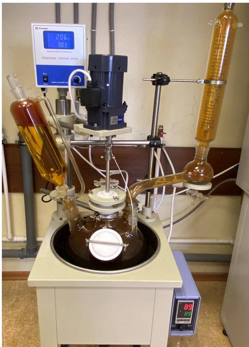
Рисунок 2.10 – Укрупненная лабораторная установка для азотнокислотного выщелачивания упорного флотоконцентрата
