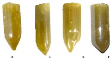
Рисунок 8 – Оптическая керамика системы  $TiCl_{0,74}Br_{0,26} - AgI$  составов: а) 7 мол. %, б) 14 мол. %, в) 20 мол. %, г) 27 мол. %  $AgI$  в  $TiCl_{0,74}Br_{0,26}$
