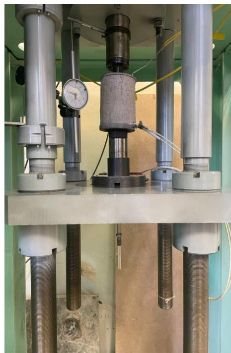
Рисунок 5.6 – Гидравлический пресс ПОИ-500 и установленная в него оснастка
