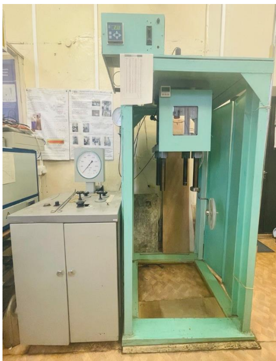
Рисунок 5.6 – Гидравлический пресс ПОИ-500 и установленная в него оснастка
