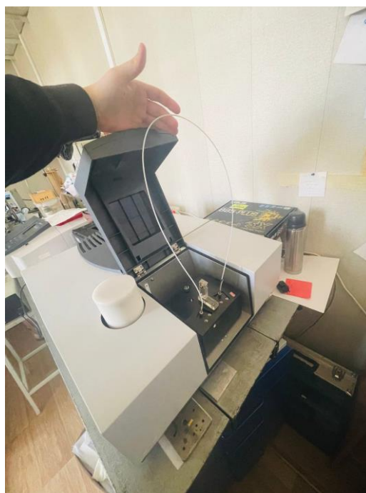
Рисунок 5.13 – Световод на основе 2 мол. % \text{TlBr}_{0,46}\text{I}_{0,54} в \text{AgCl} , подключенный к ИК Фурье спектрометру IR Prestige-21 через специальную приставку
