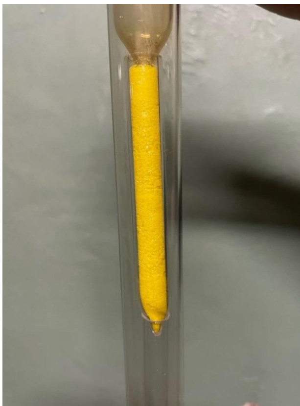
Рисунок 4.3 – Шихта в ростовой ампуле для получения монокристалла 6 мол. % \text{TlBr}_{0,46}\text{I}_{0,54} в \text{AgCl}
