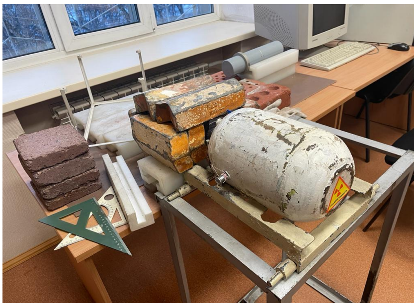
Рисунок 4.18 – Закрытый радиоактивный источник типа ИГИ-Ц-3-8 с радионуклидом – \text{Cs}^{137} в свинцовом контейнере
