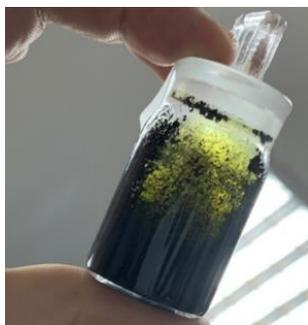
Рисунок 10 – Оптическая фотография бюкса с ИСУП через 0.1 сек после взаимодействия с 0.1 М раствором  $K_2Cr_2O_7$  в нейтральной среде
