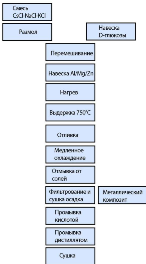
Рисунок 1 – Схема синтеза иерархически структурированной углеродной пленки (ИСУП)
