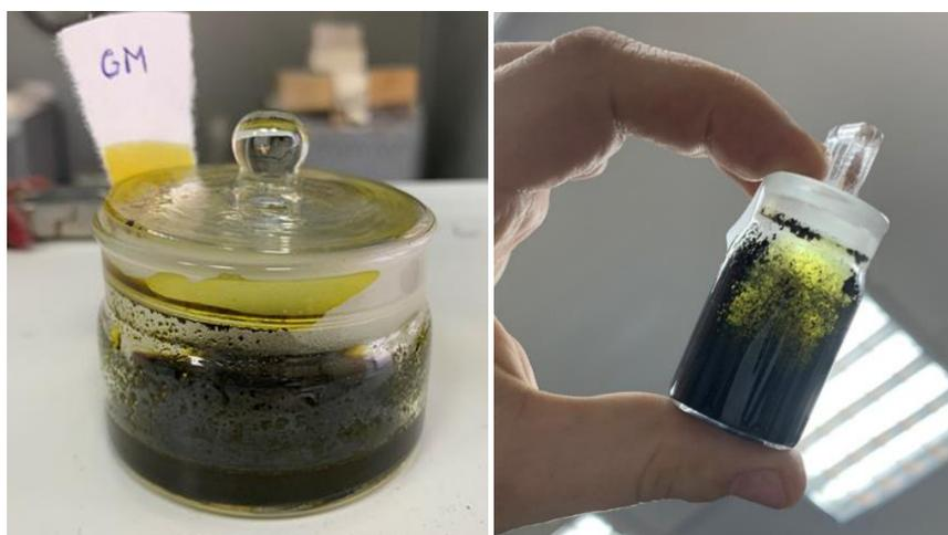
Рисунок 6.1 – Оптическая фотография бюкса с ИСУП через 0.1 сек после взаимодействия с 1 М (а) и 0.1 М (б) раствором  $K_2Cr_2O_7$  в нейтральной среде
